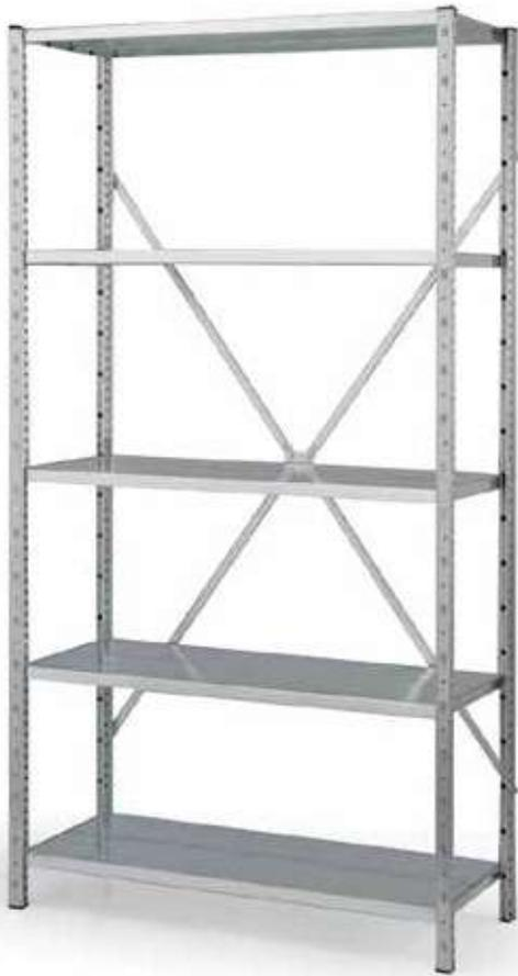
Scaffalatura metallica ad incastro i cui elementi principali sono: montanti, traversine, pannelli, correnti e/o crociere; tutti ricavati da lavorazioni di profilatura e montanti senza l'ausilio di bulloni. La portata del piano è variabile e va da 80 fino a 400 Kg c.d.u. (carico uniformemente distribuito), è dotata di una serie di accessori che la rendono adatta per diverse esigenze: magazzini, archivi, uffici etc.
