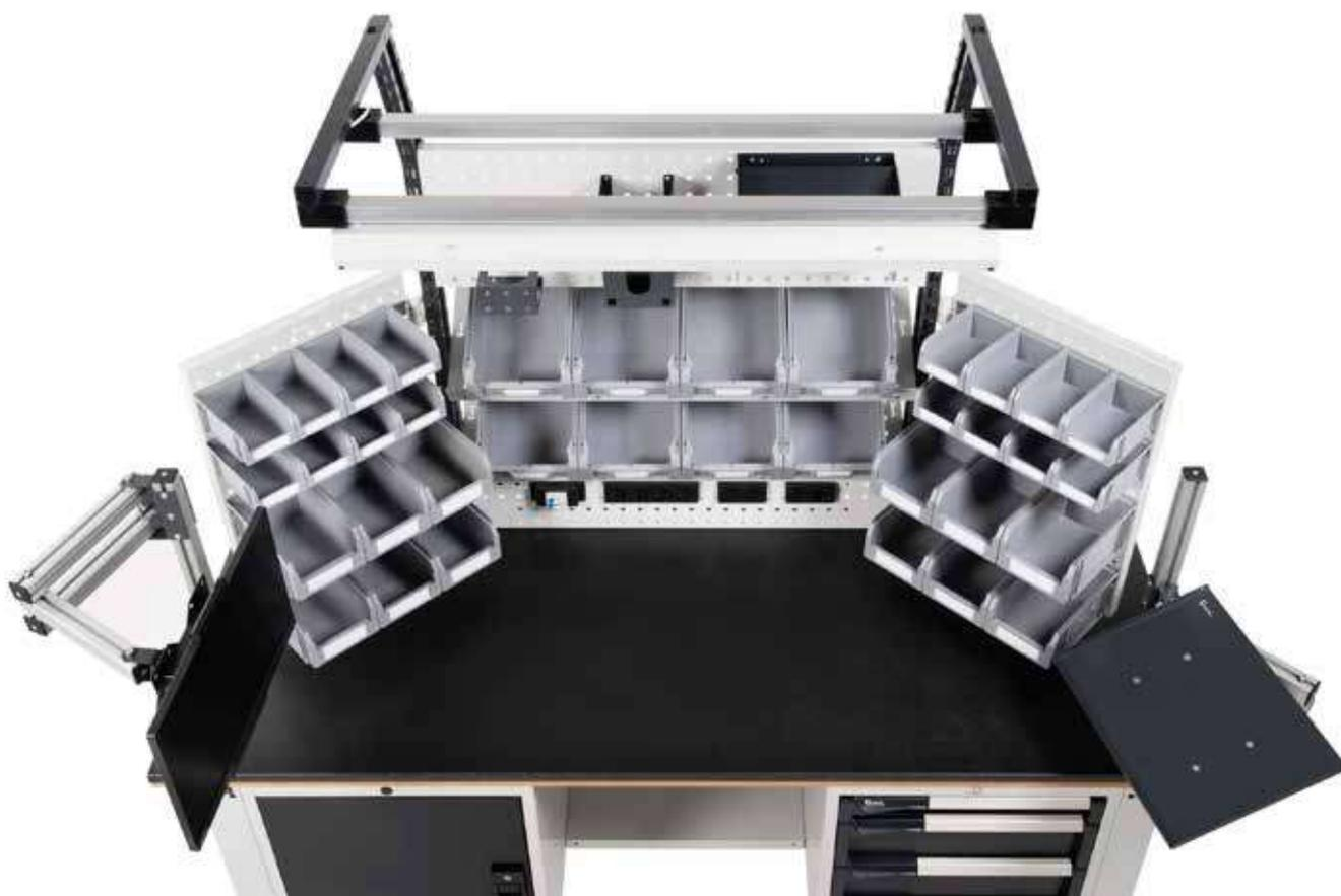
Supporti per contenitori, monitor e piani di appoggio. Il necessario per migliorare il comfort dell'area di lavoro in ogni ambiente produttivo favorendo l'ergonomia. I bracci estensibili sono regolabili a misura dell'operatore così da ridurre lo sforzo lavorativo mettendo a disposizione ogni strumento necessario.
