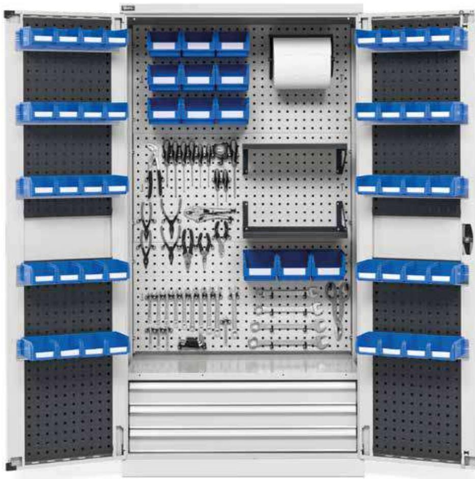
Gli Armadi con porte a battente sono costruiti in lamiera di acciaio debitamente sagomata e rinforzata per resistere ai carichi più gravosi. Sono stati studiati e realizzati in diverse misure per risolvere innumerevoli problemi di immagazzinaggio. All'interno si possono inserire più cassette o piani regolabili. I cassetti hanno un'altezza frontale di 100mm e scorrono su guide semplici o telescopiche.
